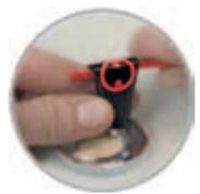
Tube aufstechen. Haftmittel in eine Öffnung füllen, bis es an der anderen austritt.
